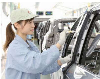
がりになるよう塗装の品質管理をしています。ボディーの塗装に、色や厚さのムラがないか、ボディーとバンパーの色に差がないかなどの確認をしています。確認の際は、専用の器具（写真1）を使って、誰が見てもきれいに仕上がりっているかを数値で判断しています」
